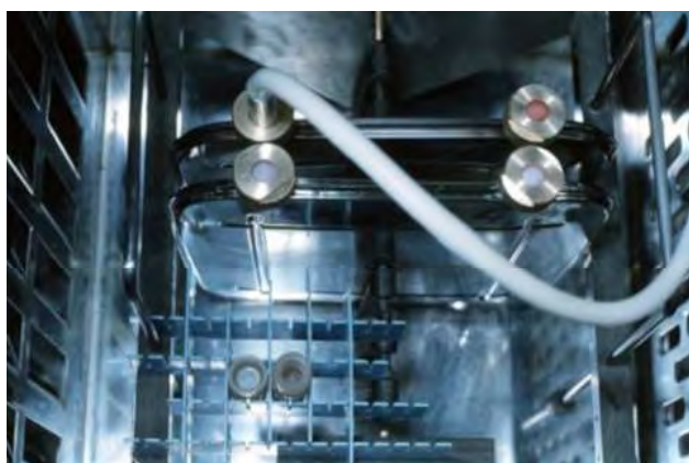
Рис. 5. Контейнер з нержавіючої сталі, розроблений у співпраці з Науково-дослідним інститутом харчової та холодильної техніки в м. Градець-Кралоу, заповнений концентратом КППК та заморожений разом з контрольними зразками в морозильній камері програмованого морозильника «Кryo-10» (Planer Biomed, Велика Британія). Температуру вимірювали в контрольному контейнері, що містив 15% гліцерину, розведеного в розчині ЦОЛІПК.
