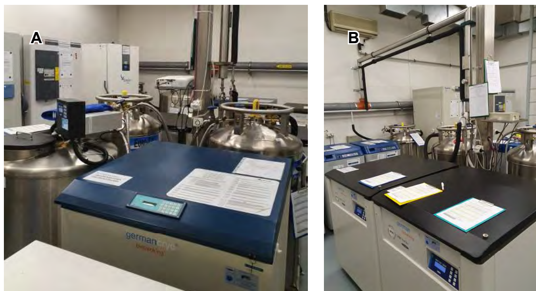
Рис. 29. Приміщення кріобанку з контейнерами для зберігання рідкого азоту та резервними ємностями для рідкого азоту (А) та великі контейнери з мідним тепловим шунтом MVE 1400 series («Chart MVE», США), що використовуються для зберігання ГКП (В).
